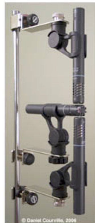
Représentation du format B et dispositif de prise de son (le canal W est manquant)
